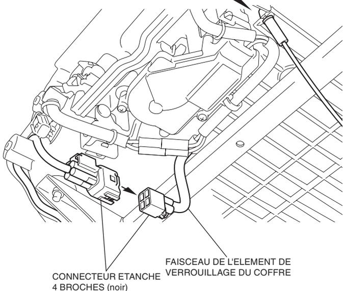
17. Déposez l'élément de verrouillage du coffre de la manière indiquée.
