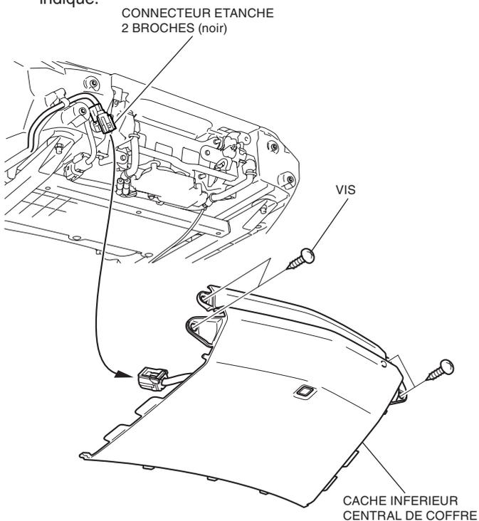
16. Débranchez le faisceau de l'élément de verrouillage du coffre comme indiqué.
