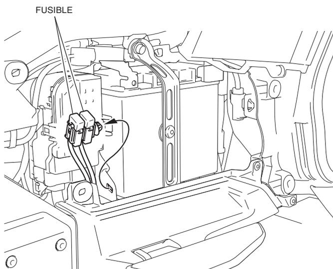
6. Déposez le cache de la platine de repose-pied gauche comme indiqué.
