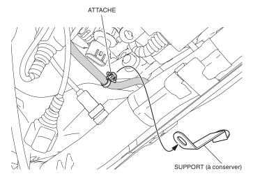
8. Faites une marque sur le faisceau du commutateur de béquille latérale à l'endroit indiqué.
